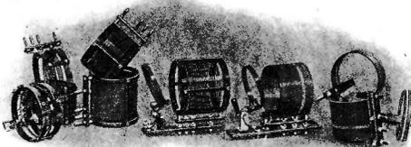
Fig. 2.—Diversos tipos y marcas de bobinas para ondas cortas. En la parte inferior aspecto del adaptador armado y listo para funcionar.
